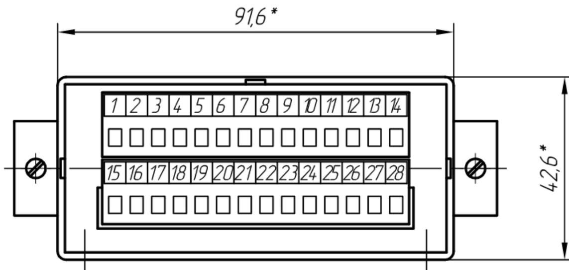
Рис.3. Прибор АКГ-1А. Клеммная колодка ХТ1.
