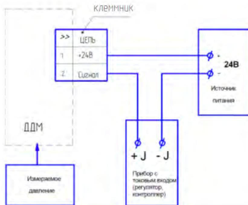
Типовая схема внешних подключений датчиков ДДМ-202х, 212х, 222х, 232х
