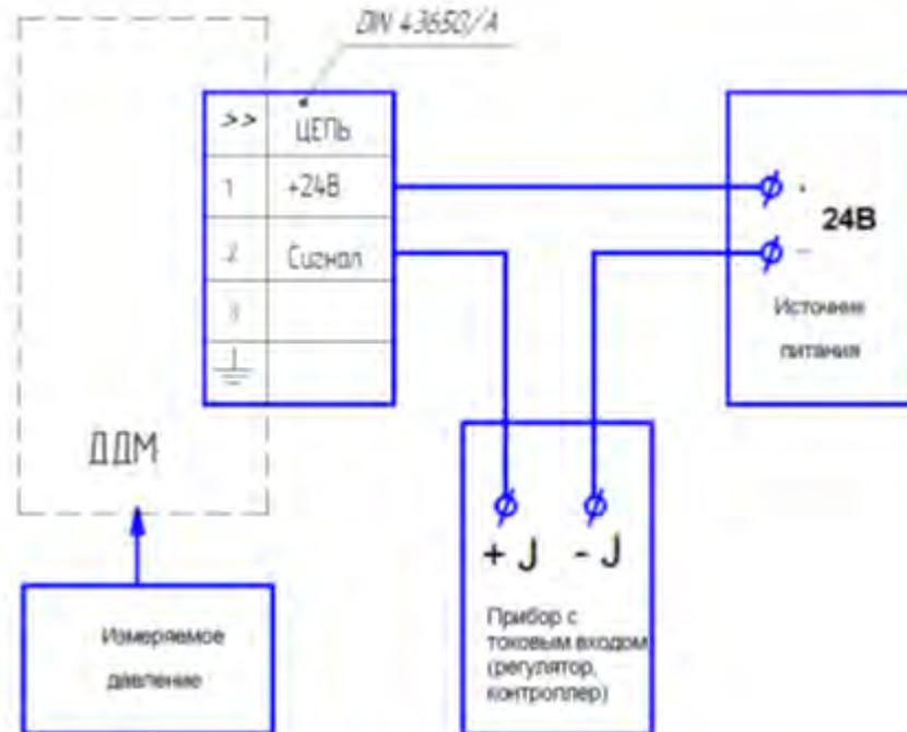
Типовая схема внешних подключений датчиков ДДМ-201х, 211х, 221х, 231х
