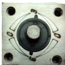
Рисунок 2.5 - Правильное положение флажка в закрытом положении
