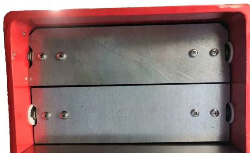
Рисунок 2.7 - Положение шиберов в закрытом положении (вид снизу)
