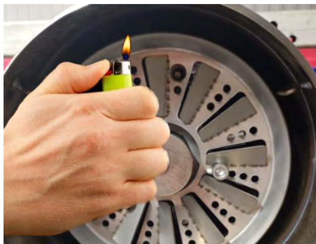
Рисунок 2.9 - Поднесение источника УФ излучения
