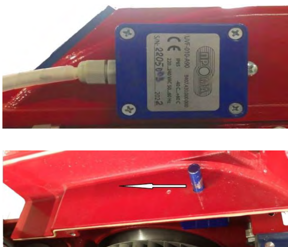
Рисунок 2.8 - Расположение фотодатчика на корпусе горелки
