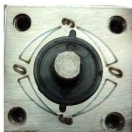
Рисунок 2.5 - Правильное положение флажка в закрытом положении
