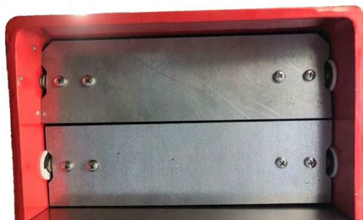
Рисунок 2.7 - Положение шиберов в закрытом положении (вид снизу)
