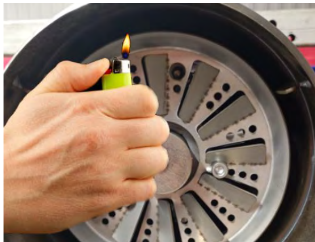
Рисунок 2.9 - Поднесение источника УФ излучения
