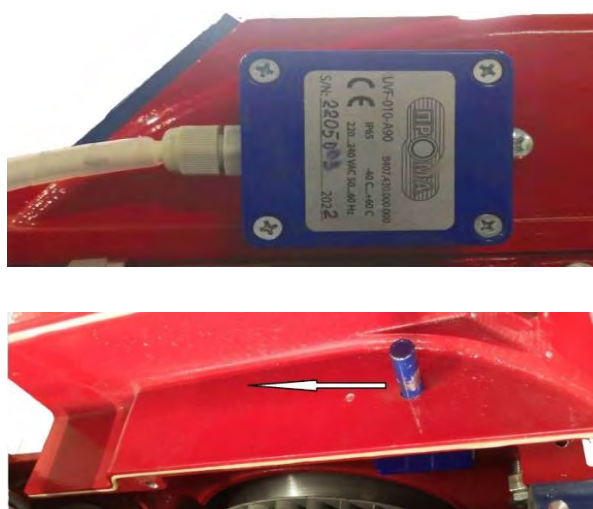
Рисунок 2.8 - Расположение фотодатчика на корпусе горелки
