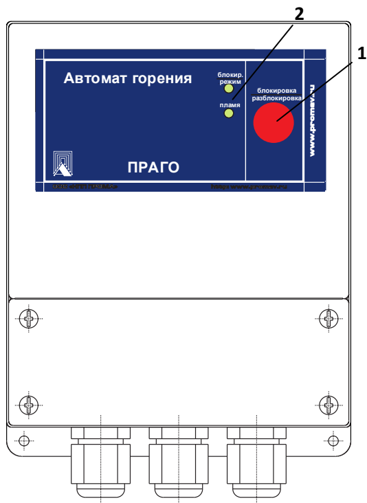
Рис. 3: Лицевая панель автомата горения ПРАГО настенного исполнения.
