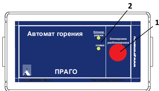
Рис. 2: Лицевая панель автомата горения ПРАГО щитового исполнения.
