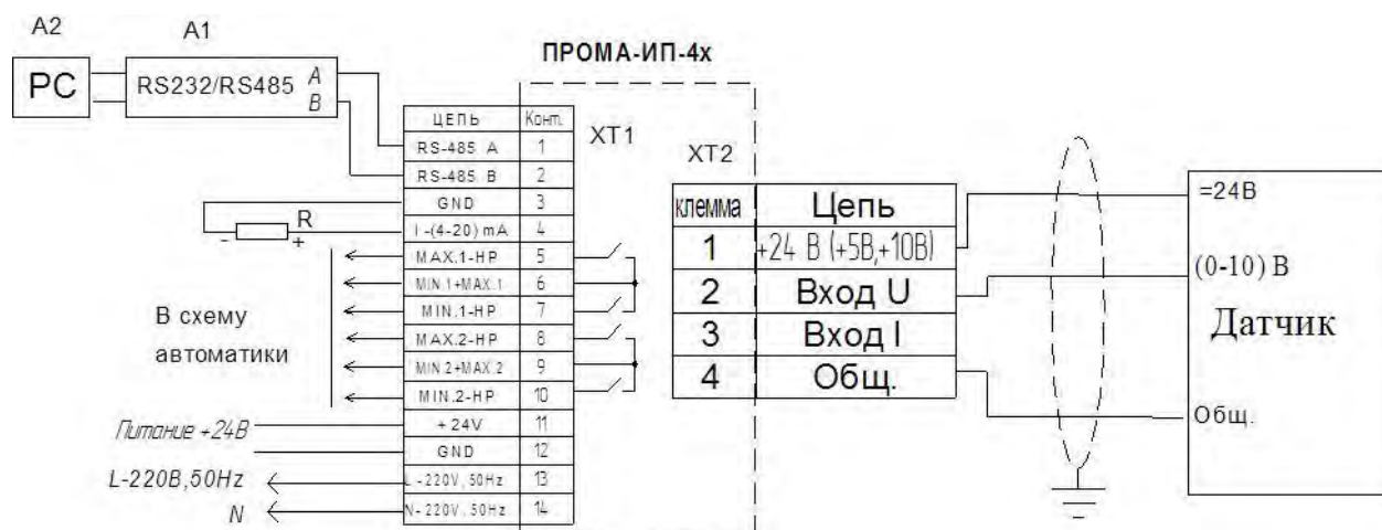
Рис.Б2. Вариант подключения измерителя с датчиком, выдающим сигнал напряжения от 0 до 10В.
