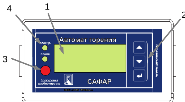
Рис. 2: Лицевая панель автомата горения САФАР щитового исполнения. 1 — ЖКИ; 2 — кнопки управления; 3 — кнопка блокировки; 4 — светодиоды.
