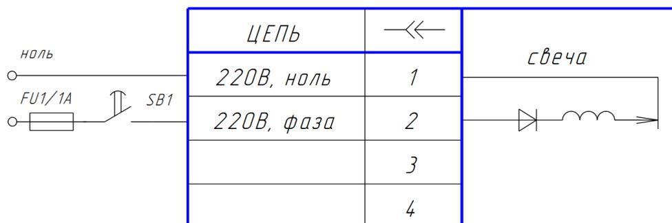
SB-1 – кнопка KM1 – 1; FU1 – предохранитель плавкий; XS1 – розетка.
