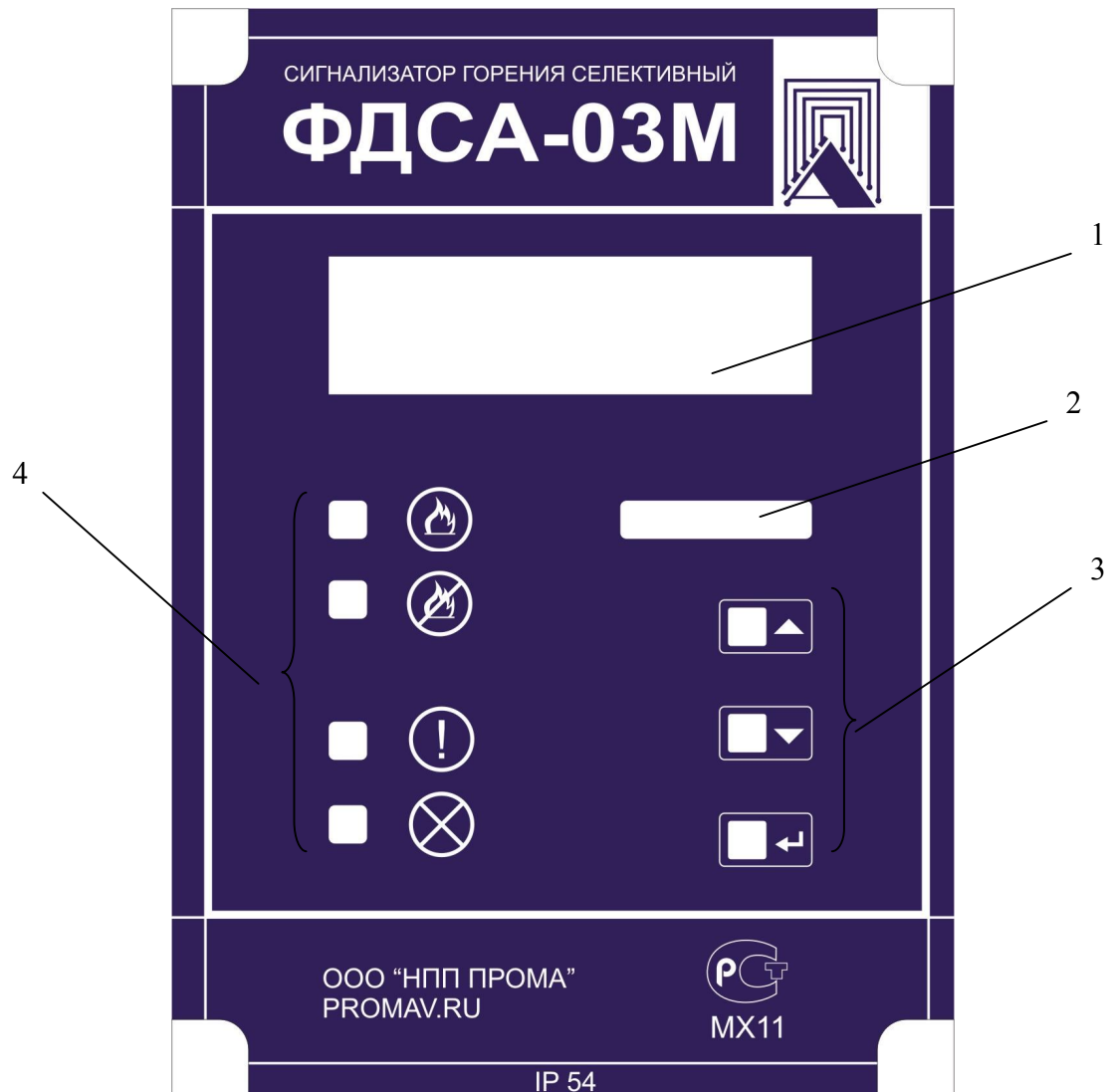
Рисунок 1. Лицевая панель устройства контроля пламени ФДСА-03М. 1 – ЖКИ; 2 – светодиодная линейка; 3 – кнопки; 4 – светодиоды.
