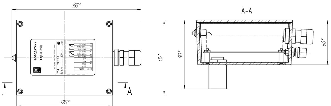
Рис.2 Конструкция фотодатчика
