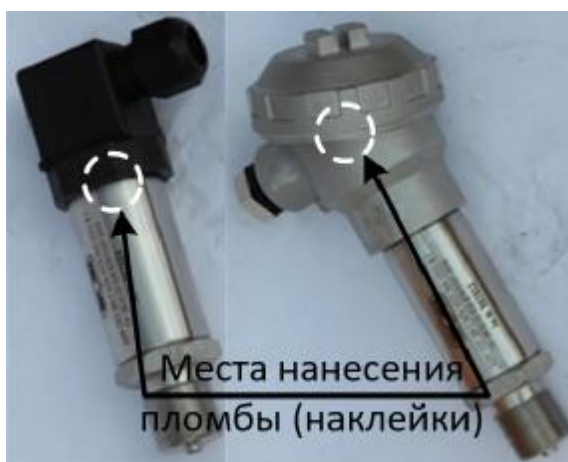
Рисунок 3 – Схема пломбировки от несанкционированного доступа
