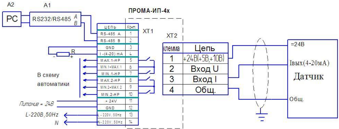
Рис.Б1. Вариант подключения измерителя с датчиком, выдающим токовый сигнал (для токовой петли 4-20 мА - провод общий ХТ2/4 исключить из схемы!).
