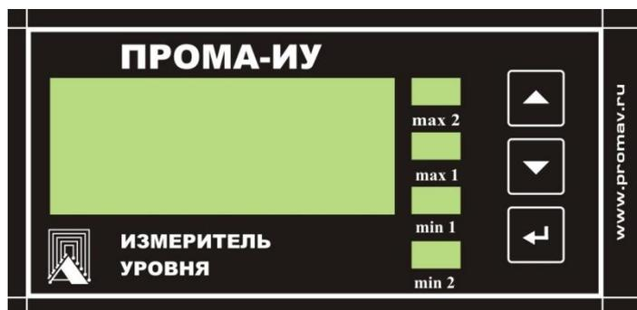
Рис.2 Внешний вид передней панели измерителей ПРОМА-ИУ
